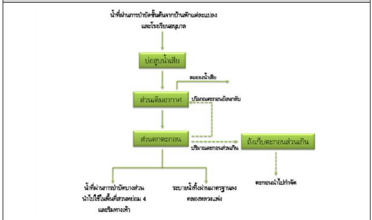
รูปที่ 1-8 ขั้นตอนการบำบัดน้ำเสียของระบบบำบัดน้ำเสียรวมรองรับพื้นที่ส่วนที่ 4
